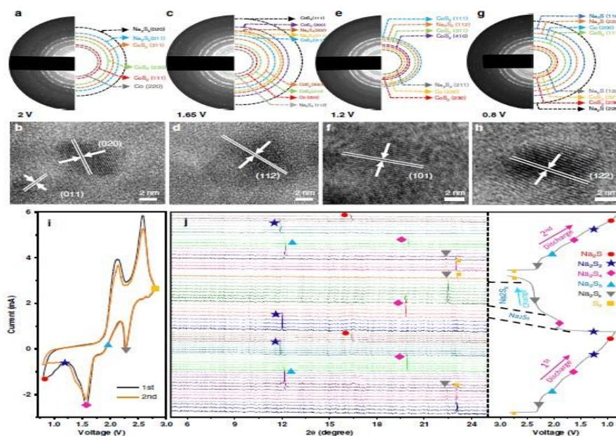
钠硫电池正极硫载体材料在电池中往往发挥出关键作用，基于此，徐茂文教授团队成功合成出能够捕获可溶性多硫化物，同时加速电化学反应的空心双锥棱柱硫载体材料。该载体材料具有独特的结构，其表面的分级结构和内部充足的空间一方面能够容纳硫反应过程中生成的中间产物，另一方面同时缓解了钠离子嵌入/脱出带来的体积膨胀。此外，该研究为进一步认识钠硫电池充/放电过程中的可逆反应机理提供了一种系统的方法。原位/非原位实验结果揭示了钠硫电池的放电反应机理，证实了该载体材料（BPCS）利用其催化特性加速了电化学反应，使短链多硫化物直接转换为长链多硫化物，减少了生成  $\text{Na}_2\text{S}_5$  的中间反应过程，从而表现出优异的电化学性能。
